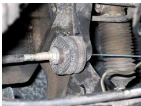
* کابل نا مناسب کلاچ (غیر قابل رگلاژ)
