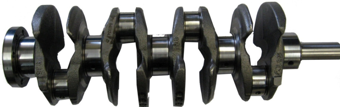
لنگ های ثابت و متحرک میل لنگ را مشخص نمایید.
