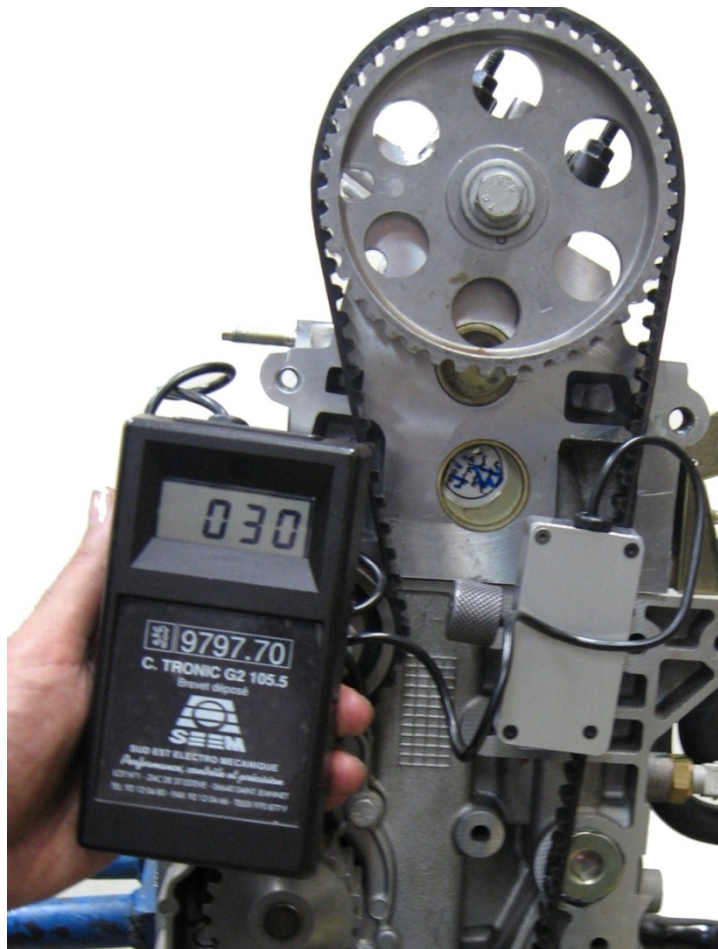
اندازه گیری کشش تسمه توسط دستگاه Tensiometer
