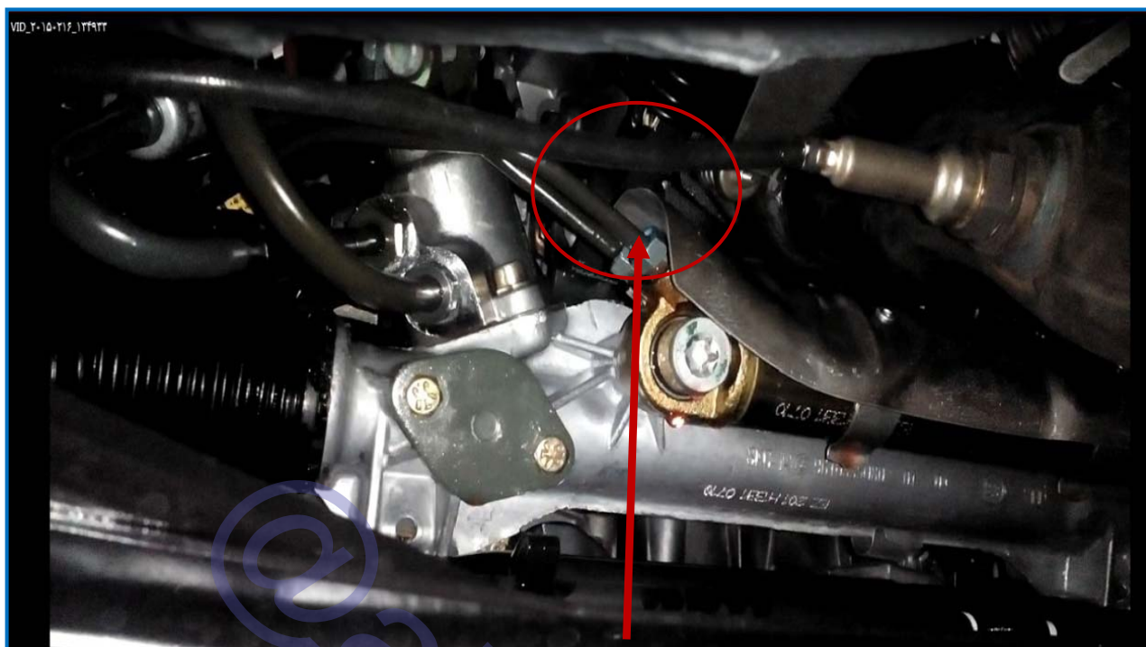
تصویر شماره 7 : نشتی از محل اتصال لوله های خم به جک هیدرولیک
